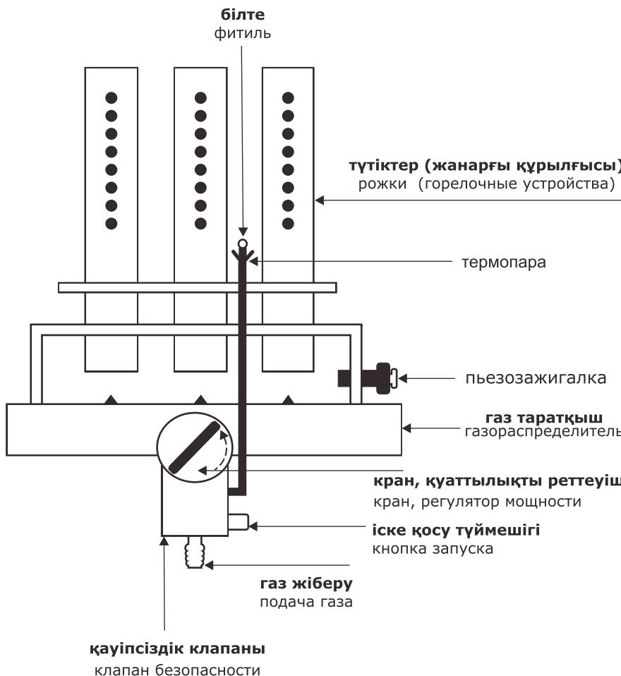
Максимальной эффективности работы котла можно добиться только при правильном использовании горелочного устройства. Ваш котел снабжен саморегулирующимся устройством подачи кислорода, а также клапаном безопасности с пьезозажигалкой, который обеспечивает запуск котла и автоматическое отключение в течение 30-40 секунд после прекращения подачи газа.
